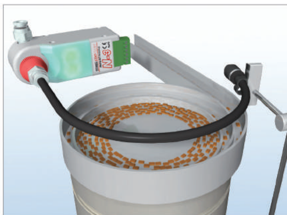
Вибрационный чашечный питатель (соединительная насадка + душевой шланг)
