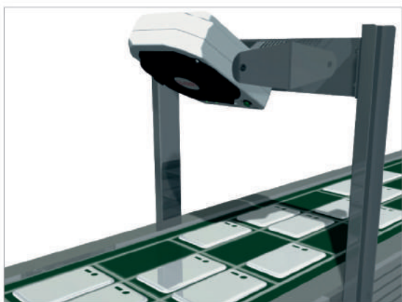
Удаление пыли с формованных деталей
