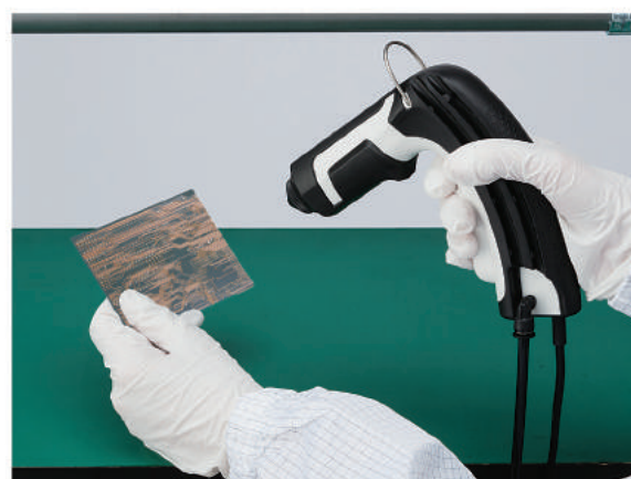
Удаление пыли с пластины
